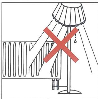
サーモスタッフバルブは、周囲の温度を敏感に感知して作動しますのでテレビ、電気ストンドなど熱源となるものを近くにおかないでください
