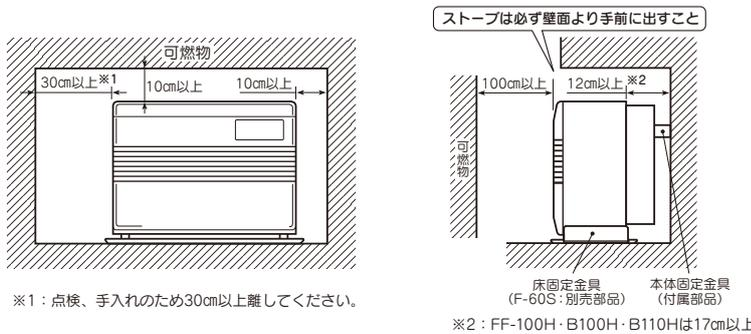
●ただし、不燃物の場合でも、保守点検と性能維持のために可燃物と同じ離隔距離にしてください。
