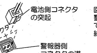
図のように電池側コネクタの突起と警報器側電池コネクタの溝をあわせて、奥までしっかりと接続し電池収納部に電池を納めます。
