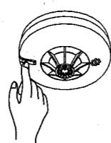
約5分間音声警報が停止します。約5分後に再度音声警報が鳴動する場合は、うちわなどで風を送り、警報器を冷やしてください。
