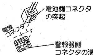
図のように電池側コネクタの突起と警報器側電池コネクタの溝をあわせて、奥までしっかりと接続し電池収納部に電池を納めます。
