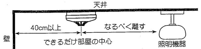
■壁面に取り付けるときは天井面下15cmから50cmまでの範囲で部屋の中心に取り付けてください。警報停止ボタン (テストボタン兼用) が下になる方向に取り付けてください。
