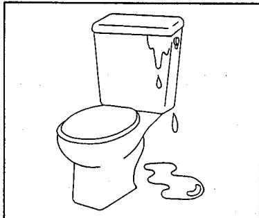
流水量が多すぎると、ボールタップが故障したとき、オーバフロー管から流れきれず、タンクからあふれて床を水びたしにしたり、階下に被害を及ぼすことがあります。また、使用水量が多くなります。
