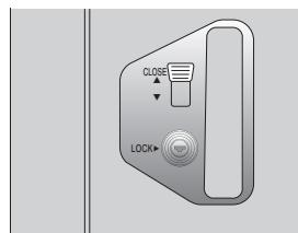
※『キー』を抜き、レバーを軽く下ろす方向に動作し、レバーが下りない事を確認してください。
