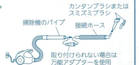
※万能アダプターは、掃除機のパイプ内径29.5~42.5(mm)に対応しています。掃除機の機種によっては、万能アダプターが取り付けられない場合があります。
