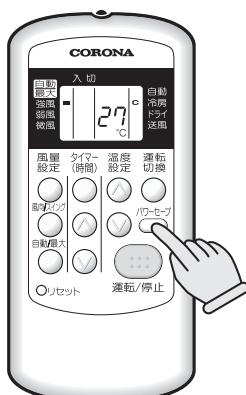
パワーセーブボタンを押すとパワーセーブ運転を開始します。
