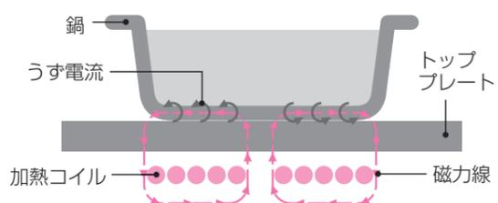
コイルに電流を流すと磁力線が発生します。この磁力線の中に鍋を置くと、鍋にうず電流が発生し、鍋の電気抵抗によって鍋自体が発熱します。
