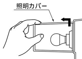
外したときと逆の手順で交換する白熱球・蛍光ランプを取り付けます。
