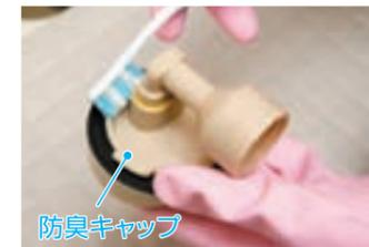
5 お掃除後は、空気噴出しキャップを右(時計回り)に回して防臭キャップに取り付けます。
