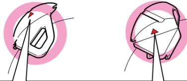
※逆流防止部材の【▲マーク】を上にして、凹凸部分を合わせ、止まるまで差し込みます。
