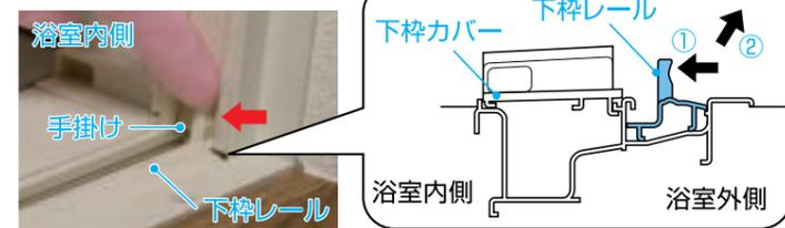
3 下枠レールを取り付け、とびらを取り付けます。
