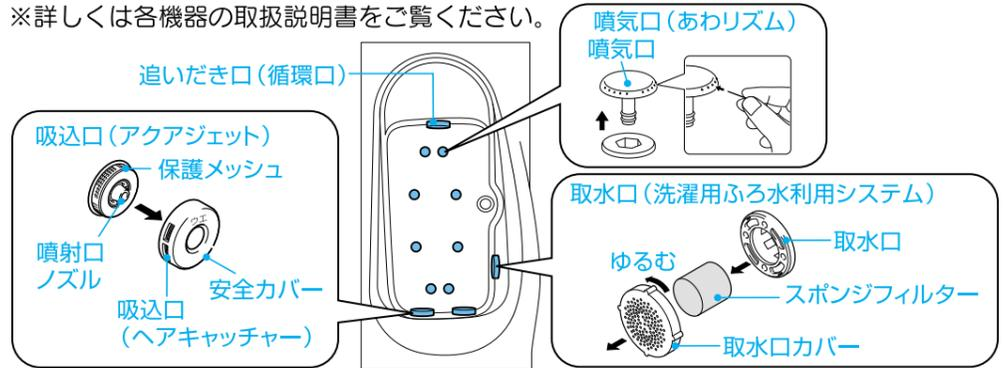
アクアジェット付き、洗濯用ふる水利用システム付きの場合は、風呂釜洗剤で配管内部をお掃除します。
