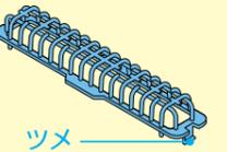
5 下枠カバーをイラストのように取り付けます。
