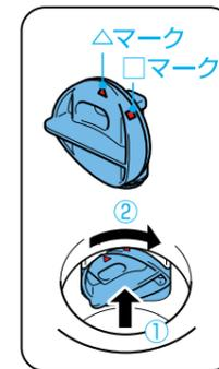
6 防臭キャップの【□マーク】を上にして穴に差し込み、【△マーク】が上にくるまで右(時計回り)に回し、止めます。
