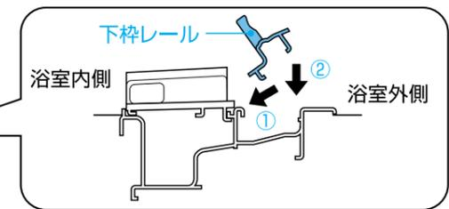
4 ドアを閉めて、反対側の下枠レールも同じようにお掃除します。
