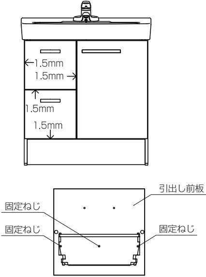
固定ねじを軽くゆるめて、引出し前板を少しずつ動かして調節します。
