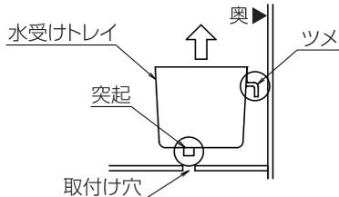
水受けトレイは上に持ち上げると外れます。取付けは水受けトレイ裏の突起を取付け穴に合わせて置きます。
