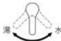
湯側開度規制付きは、安全のため湯側のレバーハンドル開度を規制しているため、湯側と水側の回転角度が異なります。
