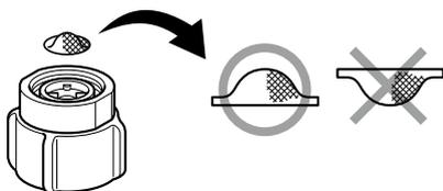
●パッキンが外れた場合、取り付ける前に、パッキンが取り付けられていた溝の部分にゴミがないか確認し、ゴミがあればきれいに掃除をしてください。
