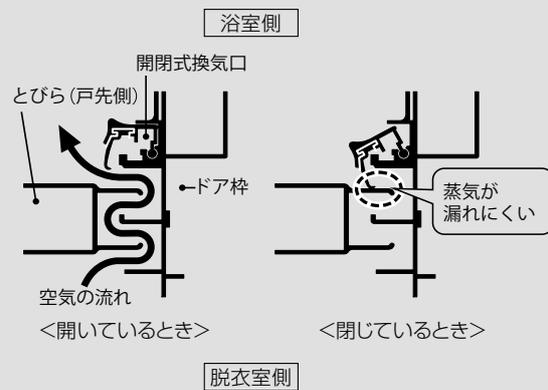
折り戸・開き戸の開閉式換気口の通気経路
