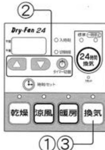
③タイマーが終わるか、換気ボタンを押し、換気ランプを消灯させる
