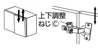
ねじ③をゆるめて扉を上下に調整した後、調整ねじ③を締め直します。
