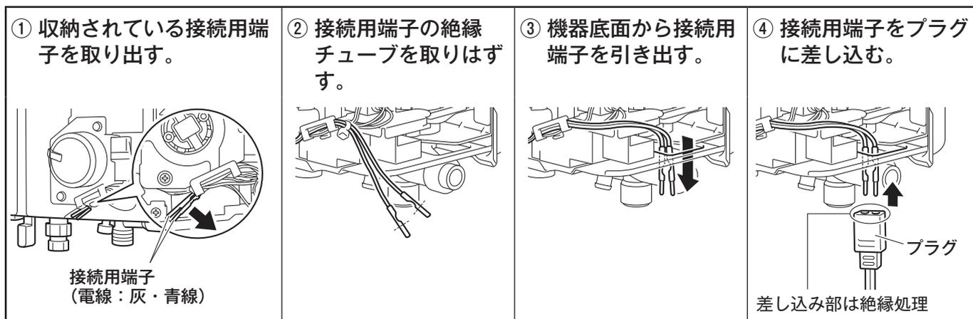
※ 接続する際は、接続用端子 (2カ所) の絶縁チューブを下図の点線 (---) 力所にカッターなどで切り込みを入れ、取りはずしてください。電線を切断したりキズを付けたりしないようご注意ください。また、接続後の配線の引き回しは、むき出しとなる接続用端子部が機器本体などの金属部分に接触しないようにしてください。接触していると安全装置が作動し、機器を使用することができなくなります。
