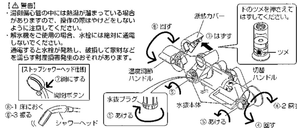
**水抜き後 通水を再開する**
