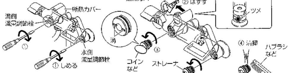
清掃後は上記の逆の手順で組み込んでください。ストレーナを締め込む時、切替ハンドルを吐水口側にしてください。
