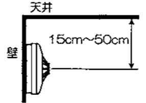
■壁面に取り付けるときは天井面下15cmから50cmまでの範囲で部屋の中心に取り付けてください。
