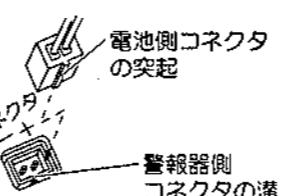
図のように電池側コネクタの突起と警報器側電池コネクタの溝をあわせて、奥までしっかりと接続し電池収納部に電池を納めます。
