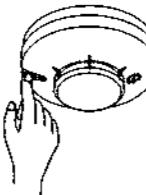
約5分間音声警報が停止します。約5分後に再度音声警報が鳴動する場合は、うちわなどで煙流入口に風を送り、煙を検知部から排除してください。
