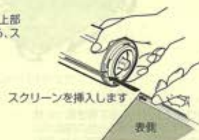
ダイヤルを「CLOSE」の方向に回転させる
