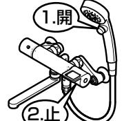
使用後は、必ずシャワーから水を出した状態にして、水栓の切替ハンドルで水を止める
