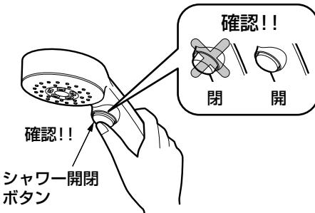
① コンフォートウェーブクリックシャワーの場合は、シャワー開閉ボタンが "開" の状態にしてホースの水を抜く。
