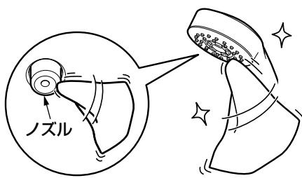
ノズルが詰まると流線が乱れる場合があります。水またはぬるま湯に浸した布をよく絞ってノズルを傷つけないように、軽く汚れをふき取ってください。強い力でふいたり、こすった場合は、ノズルが破損したり、変形してさらに流線が乱れるおそれがありますのでご注意ください。
