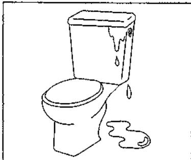
流水量が多すぎると、ボールタップが故障したとき、オーバフロー管から流れきれず、タンクからあふれて床を水びたしにしたり、階下に被害を及ぼすことがあります。また、使用水量も多くなります。
