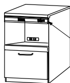
蒸気排出 ユニット
