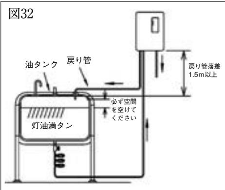
●油タンクに戻り管を接続する際は、油タンクに灯油を満タンに入れたとき、戻り管口が灯油につからないように十分注意してください。
