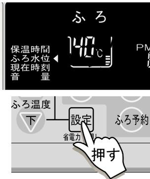
設定ボタンを押し、◀をふろ水位の右側に表示させ、水位バーが点滅していることを確認します。音声ガイドが流れます。
