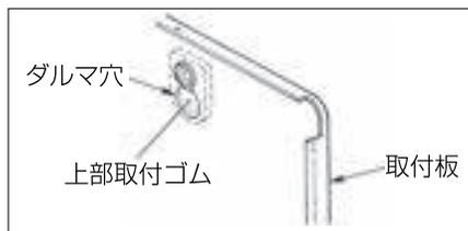
5. 座金を通した木ねじで2個の下部取付ゴムを取付板の下部2箇所のダルマ穴に取付けて壁に固定してください。
