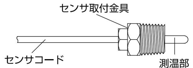
水温センサは、水道配管の途中に取付けられており、水温を測定しています。ER2000AU・ER2000SQUAUに接続されます。
